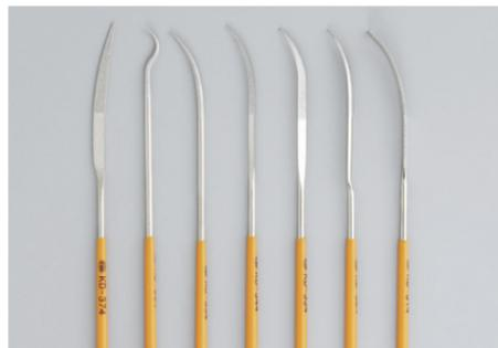
金型用に選定したダイヤモンド砥粒を使用したダイヤモンドコテヤスリです。
