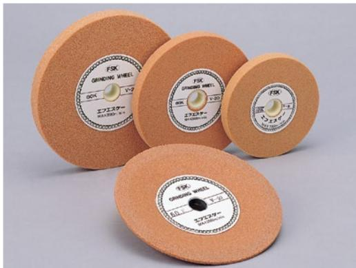
最も一般的に使用される砥石で、主に一般研削に用いられます。A砥粒より、やや硬く、破碎性にすぐれているため、鋭い切刃が得られます。
